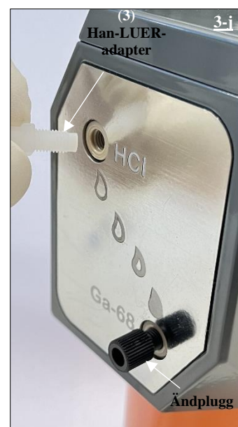
Fig. 19 Anslut han-LUER-adaptern (3) till HCl-porten på radionuklidgeneratoren.
