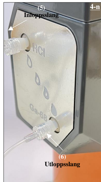
Fig. 23 Anslut inloppsänden (hon-LUER-änden) av utloppsfrlångningsledningen (6) till Ga-68-porten via adaptern.
