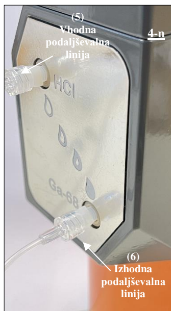
Sl. 23 Priključitev vhodnega konca (konec z ženskim priključkom LUER) na izhodno podaljševalno linijo (6) na odprtino Ga-68 prek adapterja.
