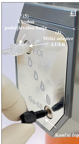
Sl. 21 Odstranitev končnega čepa z odprtine Ga-68 radionuklidnega generatorja.
