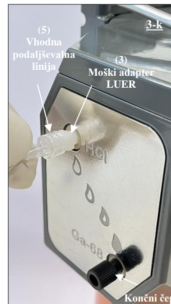
Sl. 20 Konec z ženskim priključkom LUER priključite na vhodno podaljševalno linijo (5) na odprtino HCl, priključeno z adapterjem
