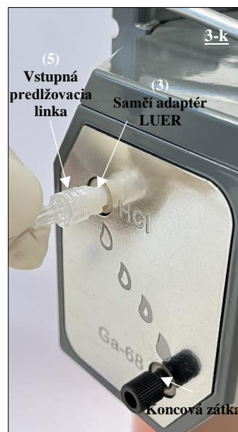
Obr. 20: Pripojenie konca vstupnej predĺžovacej linky (5) so samičou spojkou LUER k portu HCl s pripojeným adaptérom.
