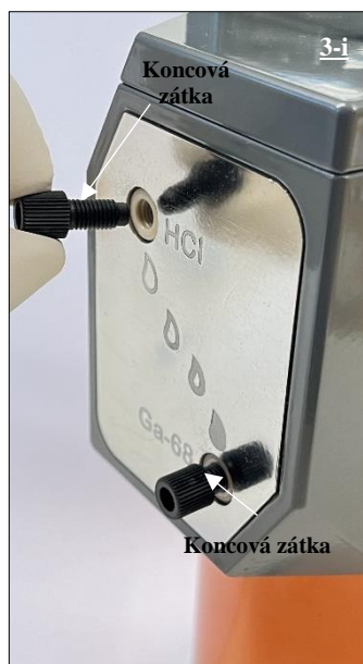
Obr. 18: Koncová zátká zakrývajúca port HCl rádionuklidového generátora pred odstránením.
