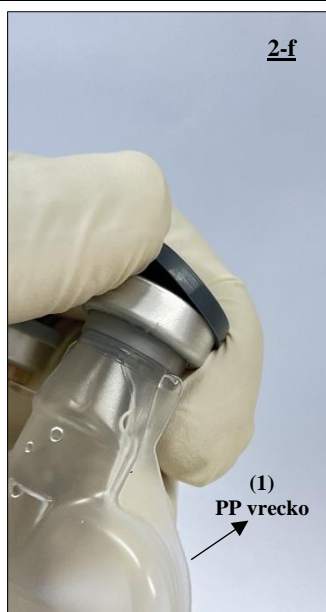
Obr. 14: Odstránenie uzáveru z PP vrečka obsahujúceho 220 ml sterilného roztoku kyseliny chlorovodíkovej s koncentráciou 0,1 mol/l (1).
