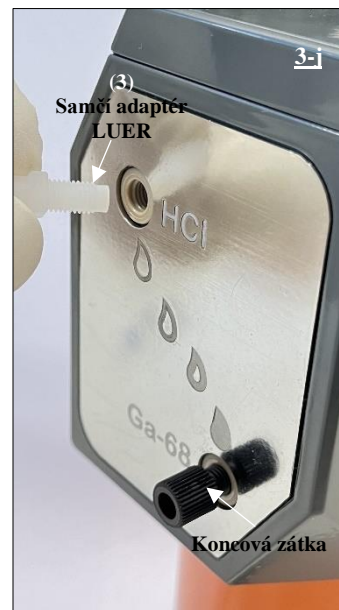
Obr. 19: Pripojenie samčieho adaptéra LUER (3) k portu HCl rádionuklidového generátora.
