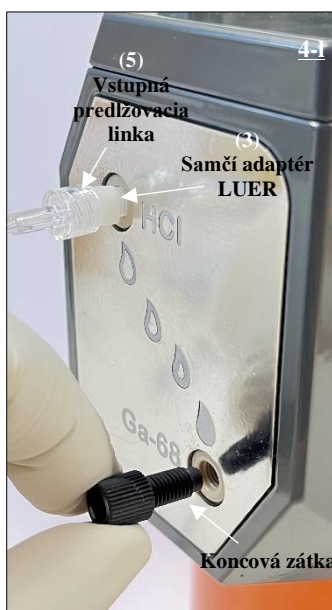
Obr. 21: Odstránenie koncovej zátky z portu Ga-68 rádionuklidového generátora.
