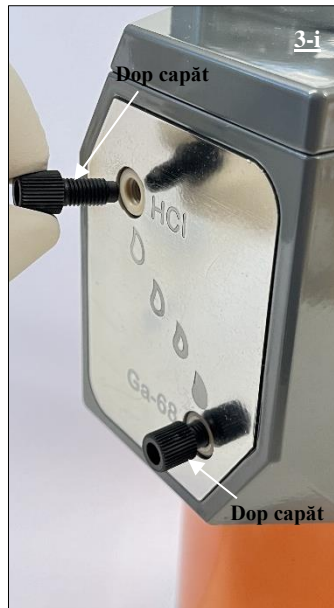
Fig. 18 Dop terminal care acoperă portul HCl al generatorului de radionuclizi, înainte de scoatere.
