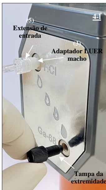
Fig. 21 Retirar o tampão da extremidade da porta Ga-68 do gerador de radionuclídeos.
