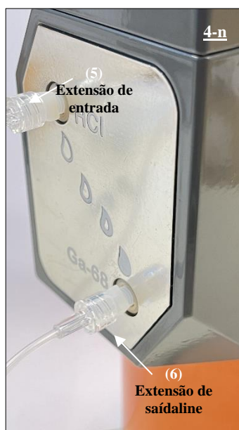
Fig. 23 Ligar a extremidade de entrada (extremidade LUER fêmea) da linha de extensão de saída (6) à porta Ga-68 através do adaptador.
