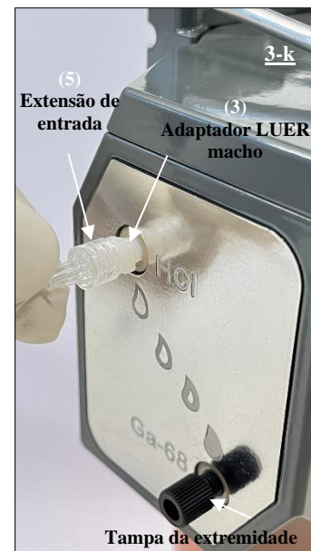
Fig. 20 Ligar a extremidade LUER fêmea da linha de extensão de entrada (5) à porta HCl acoplada no adaptador
