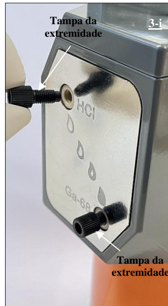
Fig. 18 Tampa que cobre a porta HCl do gerador de radionuclidos, antes da remoção.
