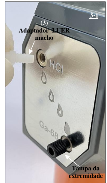
Fig. 19 Ligar o adaptador LUER macho (3) à porta HCl do gerador de radionuclidos.
