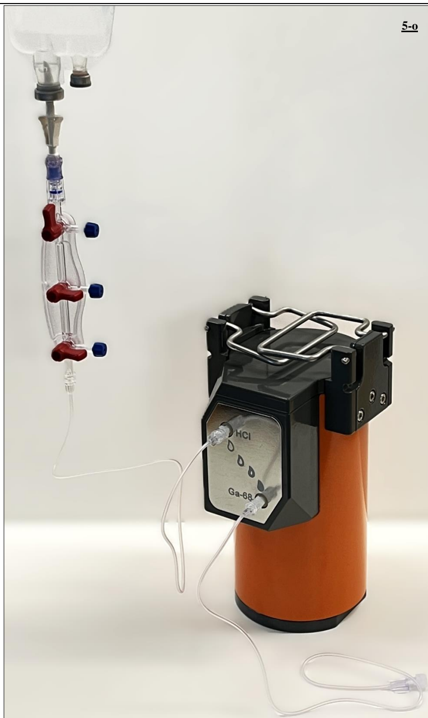
Fig. 24 Configuração final montada do gerador de radionuclídeos com todos os acessórios ligados.
