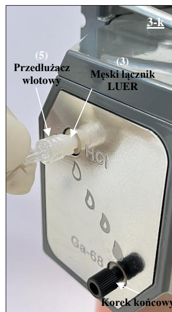
Rys. 20 Podłączenie żeńskiego końca LUER przedłużacza wlotowego (5) do portu HCl podłączonego do łącznika
