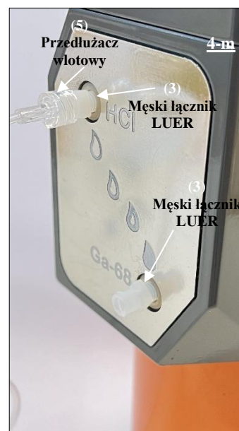
Rys. 22 Podłączenie drugiego męskiego łącznika LUER (3) do portu Ga-68.
