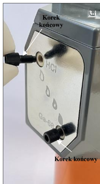
Rys. 18 Korek końcowy zakrywający port HCl generatora radionuklidu przed zdjęciem.
