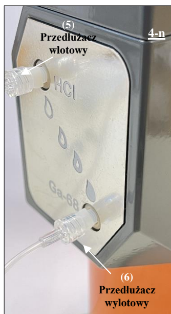
Rys. 23 Podłączenie końca wlotowego (żeńskiej końcówki LUER) przedłużacza wylotowego (6) do portu Ga-68 za pomocą łącznika.
