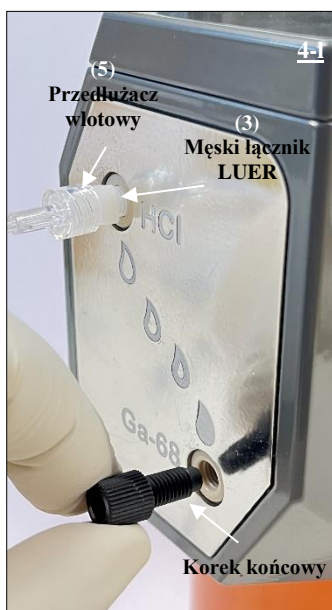
Rys. 21 Wymywanie korka końcowego z portu Ga-68 generatora radionuklidu.
