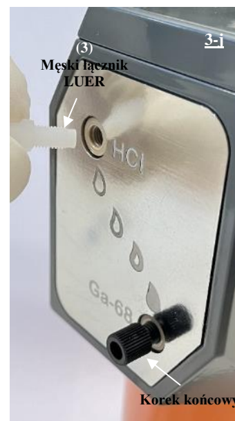
Rys. 19 Podłączenie męskiego łącznika LUER (3) do portu HCl generatora radionuklidu.
