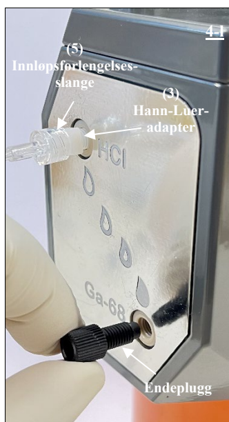
Fig. 21 Fjern endepluggen fra Ga-68-porten på radionuklidegeneratoren.
