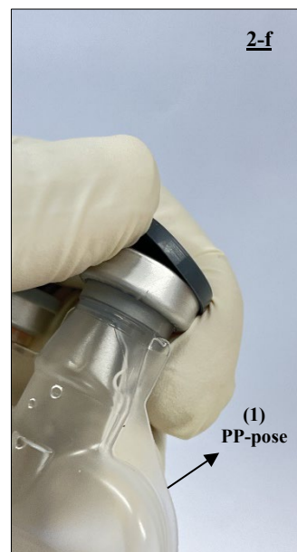
Fig. 14 Fjern hetten fra PP-posen som inneholder 220 ml steril 0,1 mol/l saltsyreoppløsning (1).
