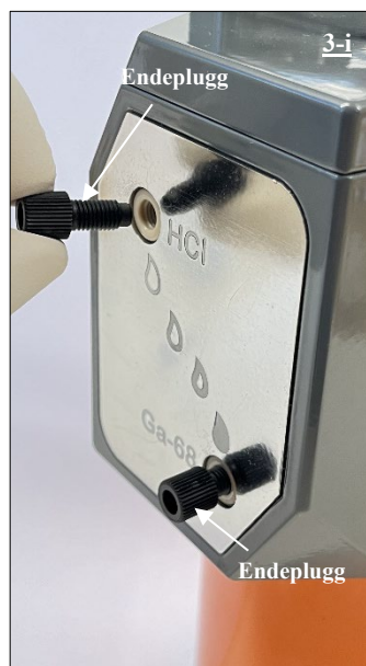
Fig. 18 Endepluggen som dekker HCl-porten på radionuklidegeneratoren, før fjerning.
