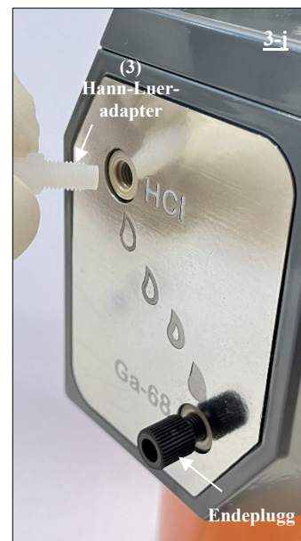
Fig. 19 Fest hann-LUER-adapteren (3) til HCl-porten på radionuklidegeneratoren.
