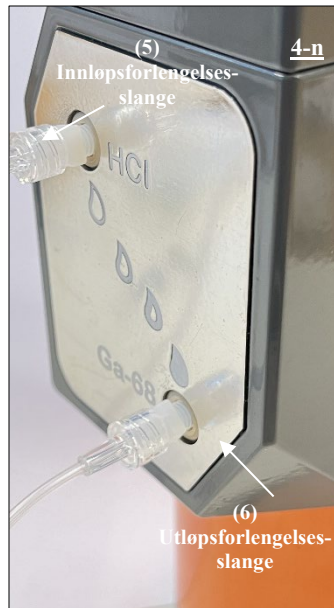
Fig. 23 Koble innløpsenden (hunn-Luer-enden) av utløpsforlengelsesslangen (6) til Ga-68-porten via adapteren.
