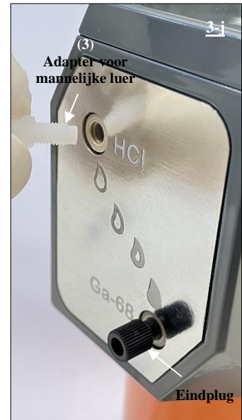
Fig. 19. Aansluiten van de adapter voor de mannelijke luer (3) op de HCl-poort van de radionuclidegenerator.
