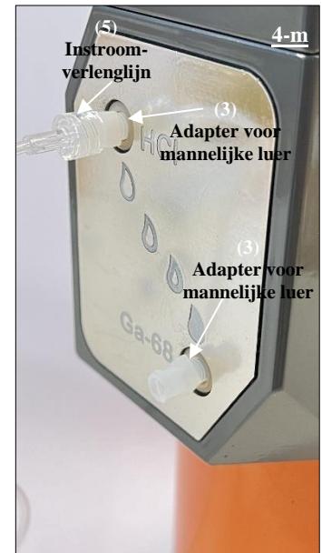
Fig. 22. De tweede adapter voor mannelijke luer (3) aansluiten op de Ga-68-poort.
