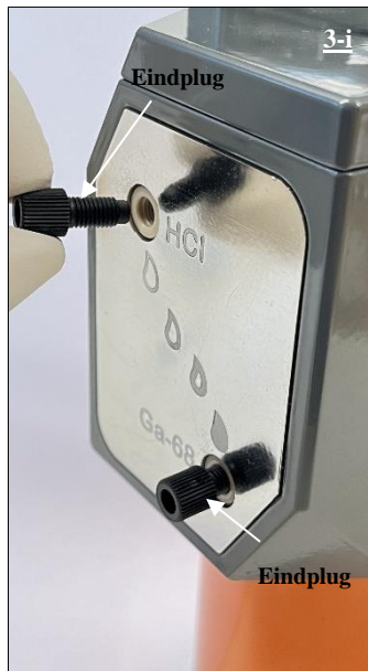
Fig. 18. Voordat hij wordt verwijderd, sluit de eindplug de HCl-poort van de radionuclidegenerator af.
