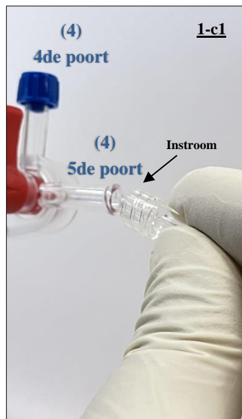
Fig. 9. Het mannelijke luer-uiteinde van de instroom-verlenglijn (5) positioneren voor het aansluiten op de vijfde poort.
