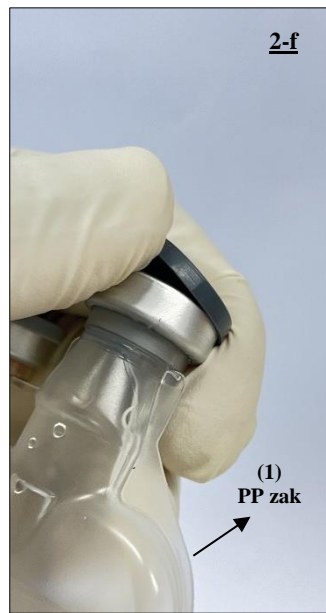
Fig. 14. De dop van de PP zak met de 220 ml steriele 0,1 mol/l zoutzuuroplossing (1) halen.
