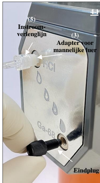
Fig. 21. De eindplug uit de Ga-68-poort van de radionuclidegenerator halen.
