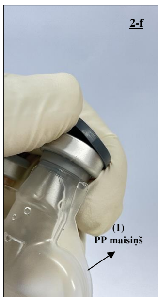
14. att. Vāciņa noņemšana no PP maisiņa, kurā atrodas 220 ml sterila 0,1 mol/l sālsskābes šķīduma (1).
