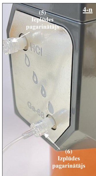
23. att. Izplūdes pagarinātāja (6) ieplūdes gala (ligzdas tipa LUER gala) pievienošana Ga-68 pieslēgvietai, izmantojot adapteri.
