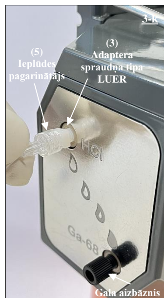
20. att. Ieplūdes pagarinātāja (5) ligzdas tipa LUER gala pievienošana HCl pieslēgvietai, kurai pievienots adapters.
