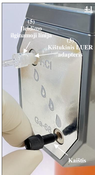
21 pav. Kaištis ištraukiamas iš radionuklidų generatoriaus Ga-68 priedado.
