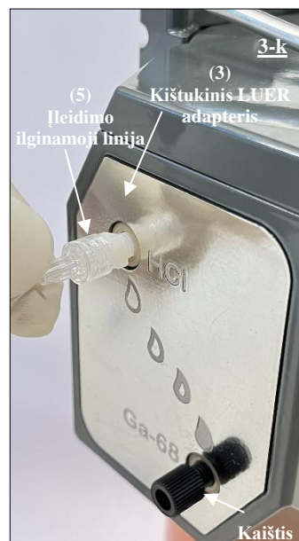
20 pav. Įleidimo ilginamosios linijos (5) lizdinė LUER jungtis prijungiama prie adapterio, prijungto prie HCl prievado.
