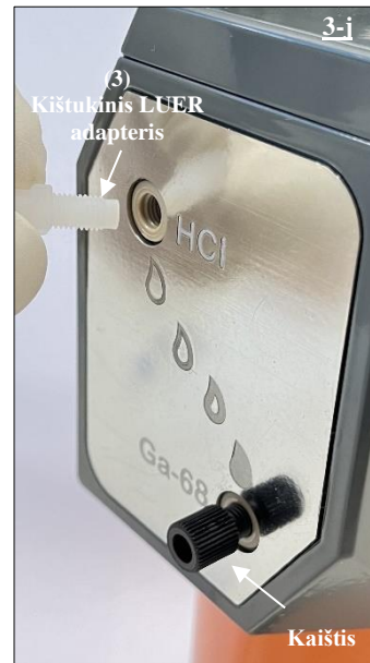
19 pav. Kištukinis LUER adapteris (3) prijungiamas prie radionuklidų generatoriaus HCl prievado.
