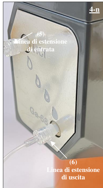
Fig. 23 Collegamento dell'estremità di entrata (estremità LUER femmina) della linea di estensione di uscita (6) alla porta Ga-68 mediante l'adattatore.
