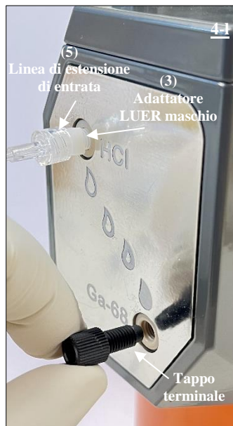
Fig. 21 Rimozione del tappo terminale dalla porta Ga-68 del generatore di radionuclidi.
