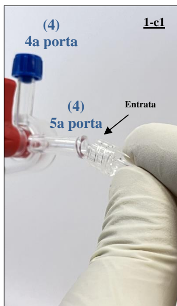
Fig. 9 Posizionamento dell'estremità LUER maschio della linea di estensione di entrata (5) prima del collegamento alla quinta porta del connettore con rubinetti (4).
