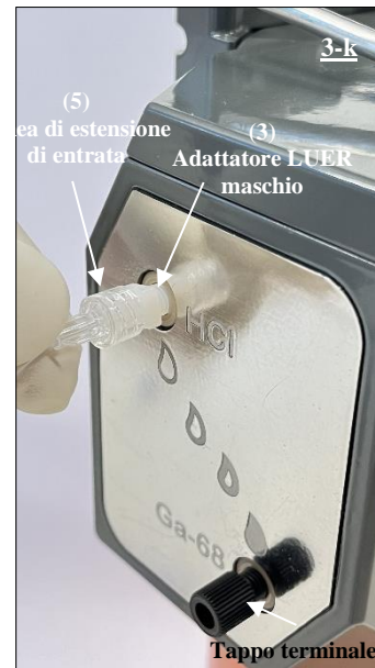
Fig. 20 Collegamento dell'estremità LUER femmina della linea di estensione di entrata (5) alla porta HCl attaccata all'adattatore.
