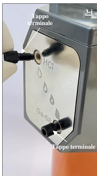
Fig. 18 Tappo terminale che copre la porta HCl del generatore di radionuclidi, prima della rimozione.
