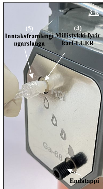
Mynd 20 Tenging kvenkyns LUER-endans á inntaksframlengingarslöngunni (5) við HCl-tengið sem er fest við millistykkið
