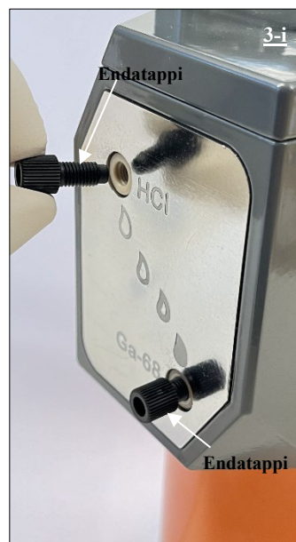
Mynd 18 Endatappinn sem hylur HCl-tengið á geislageitinni, áður en hann er fjarlægður.
