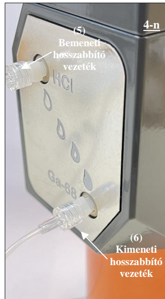
23. ábra A kimeneti hosszabbító vezeték (6) bemeneti végének (LUER-aljzat-vég) csatlakoztatása a Ga-68-porthoz a korábban csatlakoztatott adapteren keresztül.
