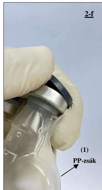
14. ábra A 220 ml, steril 0,1 mol/l sósavoldatot (1) tartalmazó PP-zsák kupakjának eltávolítása.
