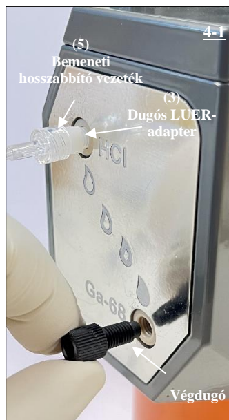
21. ábra A végdugó eltávolítása a radioaktívizotóp-generátor Ga-68-portjáról.
