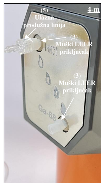
Sl. 22 Spajanje drugog muškog LUER priključka (3) na Ga-68 otvor.
