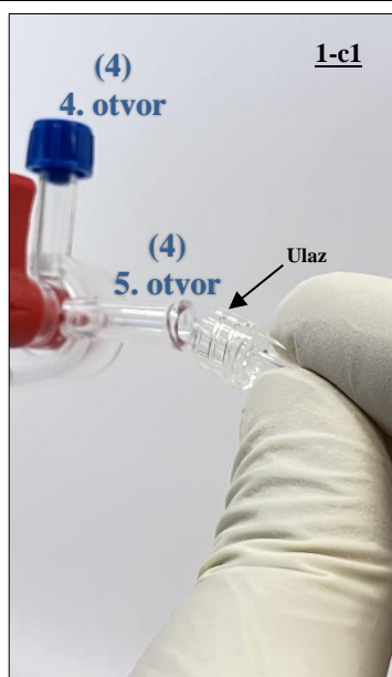
Sl. 9 Postavljanje muškog LUER priključka ulazne produžne linije (5) prije spajanja s petim otvorom.
