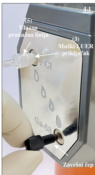
Sl. 21 Vađenje čepa iz Ga-68 otvora generatora radionuklida.
