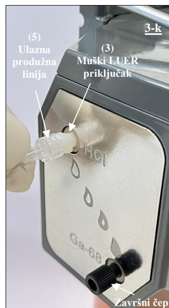
Sl. 20 Spajanje ženskog LUER kraja ulazne produžne linije (5) na HCl otvor spojen na priključak
