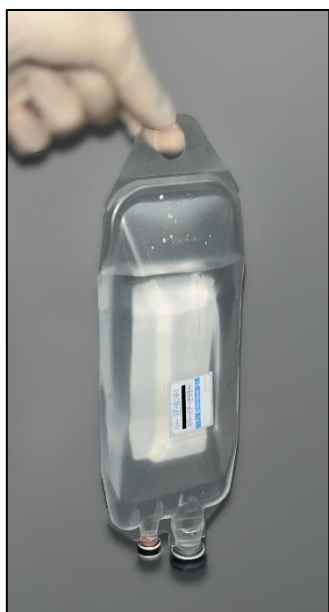
Sl. 1 (1) 220 ml sterilne otopine 0,1 mol/l kloridne kiseline u polipropilenskoj vrećici [PP vrećica]
