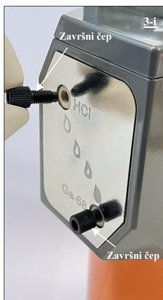
Sl. 18 Čep zatvara HCl otvor generatora radionuklida, prije uklanjanja.
