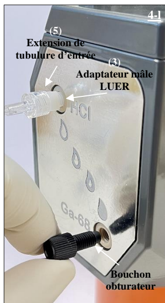
Fig. 21 Retrait du bouchon obturateur du port Ga-68 du générateur radiopharmaceutique
