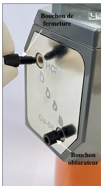
Fig. 18 Bouchon obturateur couvrant le canal HCl du générateur radiopharmaceutique, avant retrait
