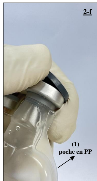
Fig. 14 Retrait de la coiffe de la poche en PP, contenant les 220 mL de solution stérile d'acide chlorhydrique 0,1 mol/L (1)
