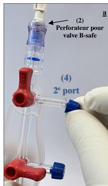
Fig. 27 Retrait de la coiffe du deuxième port de la rampe de robinets (4) pour préparer la connexion de la seringue
