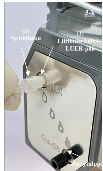
Kuva 20. Syöttöletkun (5) naaras-LUER-pään liittäminen HCl-porttiin liitettynä sovittimeen.
