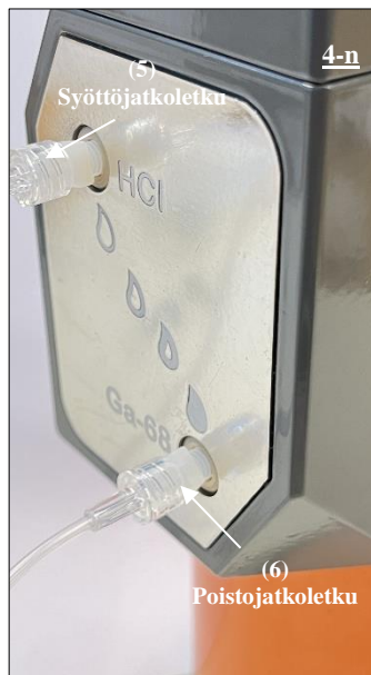
Kuva 23. Poistoletkun (6) syöttöpään (naaras-LUER-pään) liittäminen liittimellä Ga-68-porttiin.
