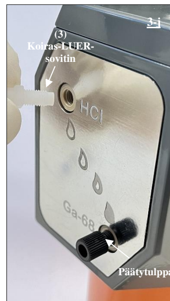
Kuva 19. Koiras-LUER-liittimen (3) liittäminen radionuklidigeneraattorin HCl-porttiin.
