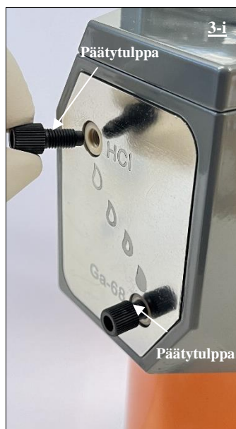
Kuva 18. Radionuklidigeneraattorin HCl-portin päätytulppa ennen irrottamista.
