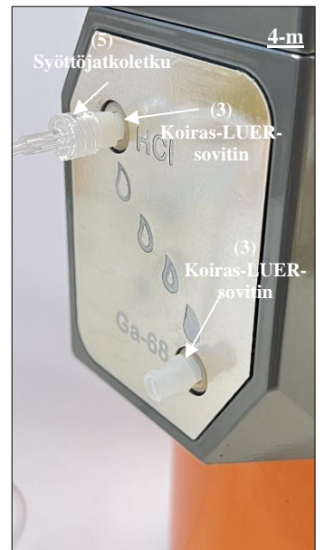
Kuva 22. Toisen koiras-LUER-liittimen (3) liittäminen Ga-68-porttiin.
