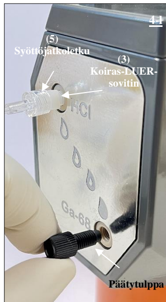
Kuva 21. Tulpan irrottaminen radionuklidigeneraattorin Ga-68-portista.
