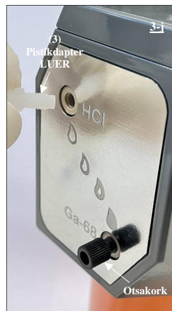
Joonis 19. LUER-luku pistikadapteri (3) kinnitamine radionukliidgeneraatori HCl-pordiga.
