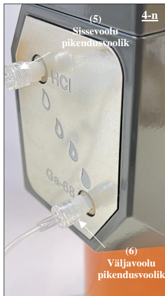
Joonis 23. Väljavoolu pikendusvooliku (6) LUER-luku pistikotsa ühendamise adapteri kaudu Ga-68 pordiga.
