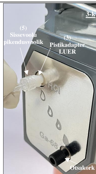
Joonis 20. Sissevoolu pikendusvooliku (5) LUER-luku pistikotsa kinnitamine HCl-pordi adapteri kaudu
