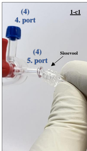
Joonis 9. Sissevooluliini (5) LUER-luku pistikotsa positioneerimine enne viienda pordiga ühendamist.
