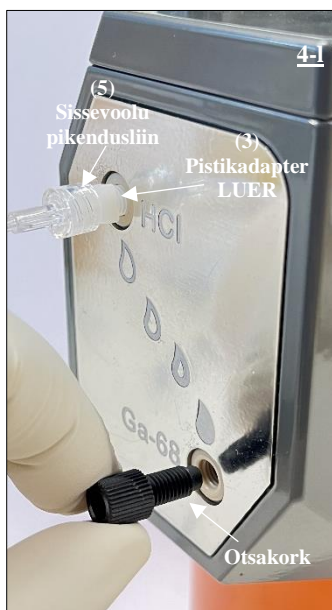
Joonis 21. Otsakorgi eemaldamine radionukliidgeneraatori Ga-68 pordist.
