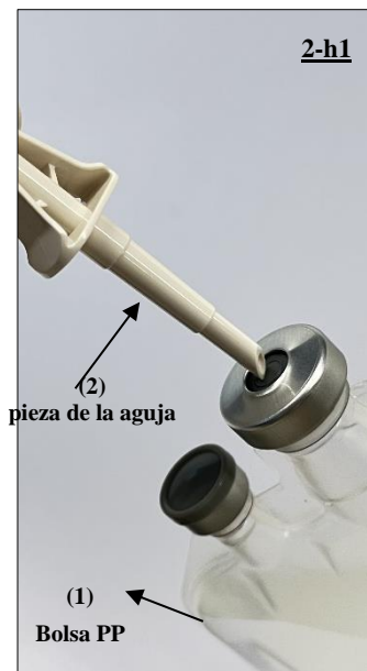
Fig. 16 Alineación de la pieza de la aguja del punzón B-safe (2) con el orificio de la bolsa PP (1) antes de la inserción.
