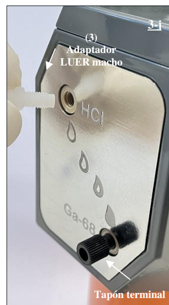
Fig. 19 Fijación del adaptador LUER macho (3) al puerto de HCl del generador de radionucleidos.
