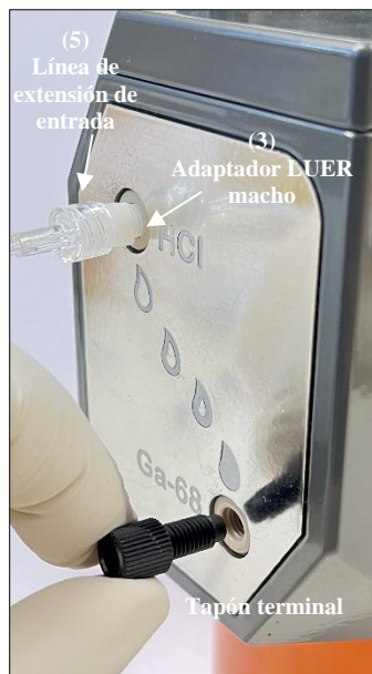
Fig. 21 Retirada del tapón terminal del puerto de Ga-68 del generador de radionucleidos.
