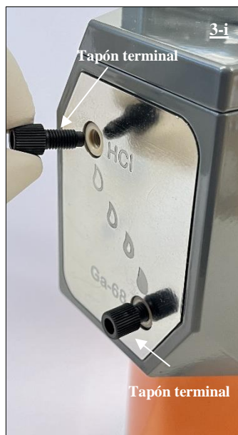
Fig. 18 Tapón terminal que cubre el puerto de HCl del generador de radionucleidos, antes de retirarlo.
