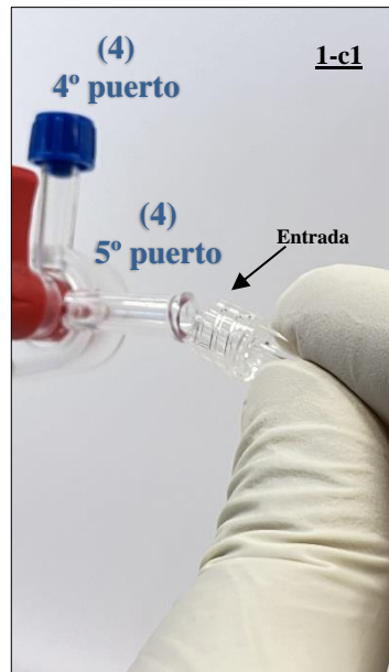
Fig. 9 Colocación del extremo LUER macho de la línea de extensión de entrada (5) antes de la conexión al quinto puerto del banco de llaves.
