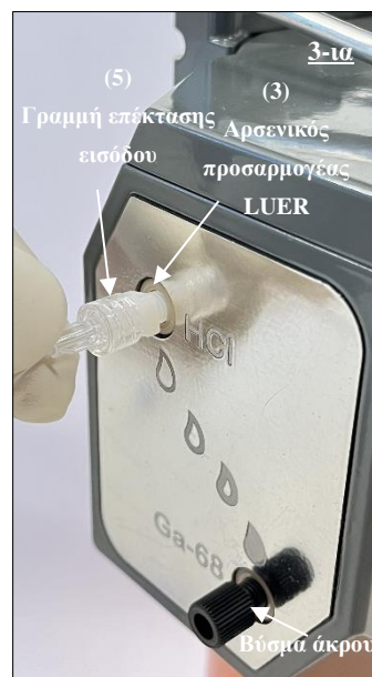
Εικ. 20 Σύνδεση του θηλυκού άκρου LUER της γραμμής επέκτασης εισόδου (5) στη θύρα HLC που είναι προσαρτημένη στον προσαρμογέα.
