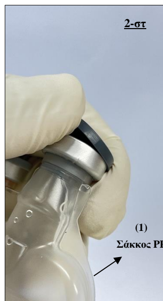
Εικ. 14 Αφαίρεση του πόματος από τον σάκκο PP που περιέχει τα 220 ml στείρου διαλύματος υδροχλωρικού οξέος 0,1 mol/L (1).
