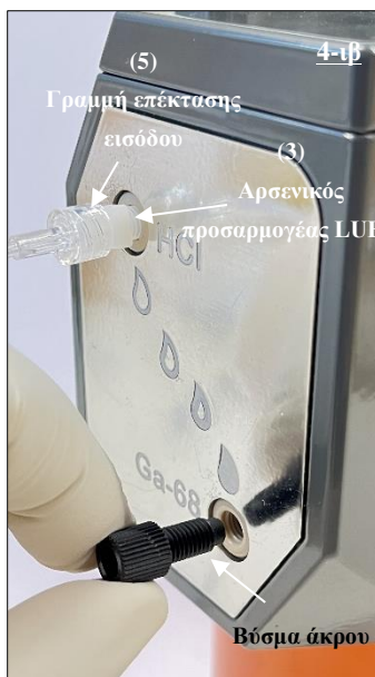
Εικ. 21 Αφαίρεση του βύσματος άκρου από τη θύρα Ga-68 της γεννήτριας ραδιοουκλιδίου.
