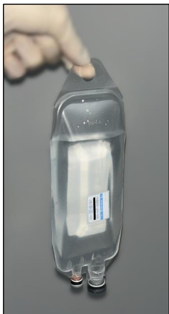
Εικ. 1(1) 220 ml στείρου υδροχλωρικού οξέος 0,1 mol/l σε σάκκο πολυπροπυλενίου [σάκκο PP]
