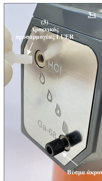
Εικ. 19 Προσάρτηση του αρσενικού προσαρμογέα LUER (3) στη θύρα HCl της γεννήτριας ραδιονουκλιδίου.
