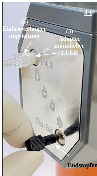
Abb. 21 Entfernen des Endstopfens vom Ga-68-Port des Radionuklidgenerators.
