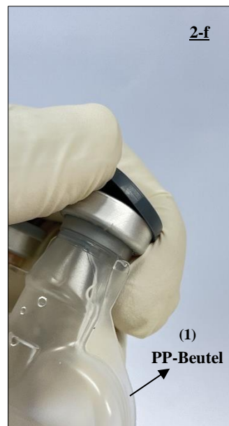
Abb. 14 Entfernen der Kappe von dem PP-Beutel, der die 220 ml sterile Salzsäurelösung 0,1 mol/l enthält (1).
