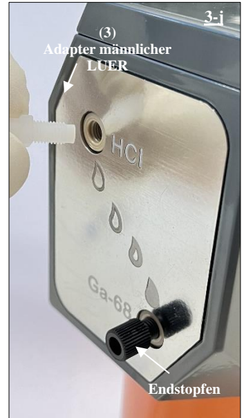
Abb. 19 Anbringen des männlichen LUER-Adapters (3) am HCl-Port des Radionuklidgenerators.
