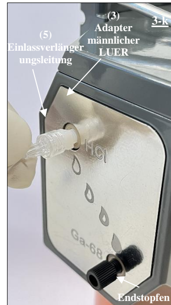
Abb. 20 Anschluss des weiblichen LUER-Endes der Einlassverlängerungsleitung (5) an den mit dem Adapter verbundenen HCl-Port
