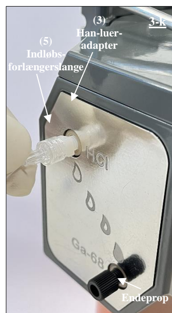
Fig. 20 Tilslutning af hun-luer-enden af indløbsforlængerslangen (5) til adapteren, der sidder i HCl-åbningen.
