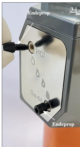
Fig. 18 Endeprop i radionuklidgeneratorens HCl-åbning før fjernelse.
