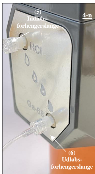
Fig. 23 Tilslutning af indløbsenden (hun-luer-enden) af udløbsforlængerlangen (6) til Ga-68-åbningen via adapteren.
