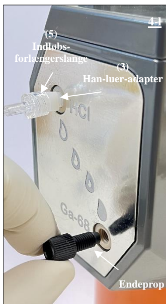
Fig. 21 Fjernelse af endeproppen fra radionuklidgeneratorens Ga-68-åbning.
