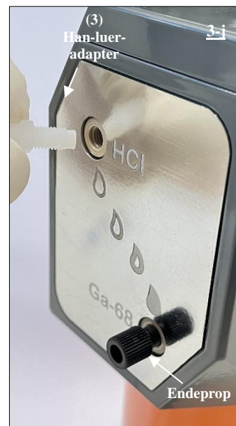
Fig. 19 Han-luer-adapteren (3) sættes i radionuklidgeneratorens HCl-åbning.
