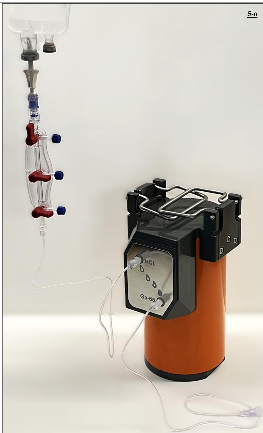
Fig. 24 Endeligt monteret konfiguration af radionuklidgeneratoren med alt tilbehør tilsluttet.
