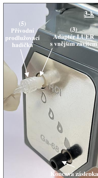
Obr. 20 Připojení konce LUER s vnitřním závitem přivodní prodlužovací hadičky (5) k HCl portu s připojeným adaptérem.
