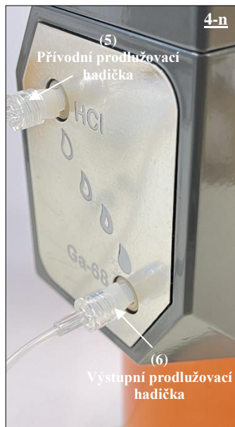
Obr. 23 Připojení přívodního konce (LUER s vnitřním závitem) výstupní prodlužovací hadičky (6) k portu Ga-68 prostřednictvím adaptéru.
