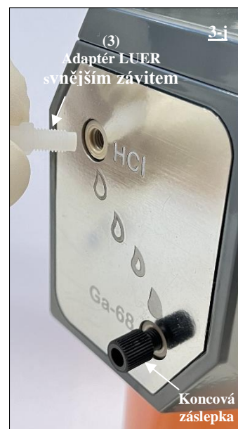
Obr. 19 Připojení adaptéru LUER s vnějším závitem (3) k HCl portu radionuklidového generátoru.
