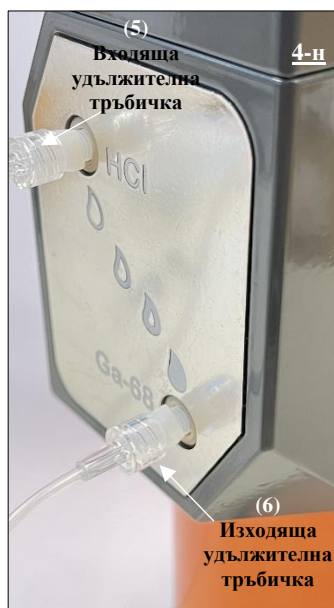
Фиг. 23 Свързване на входящия край (женски LUER край) на изходящата удължителна тръбичка (6) към порта Ga-68 чрез адаптера.
