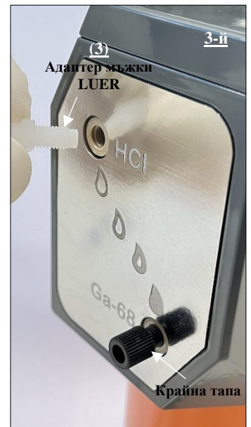
Фиг. 19 Прикрепване на мъжкия LUER адаптер (3) към HCl порта на радионуклидния генератор.
