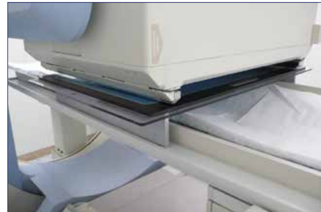
Halterung einer Kamera für eine 57 Co Flächenquelle
