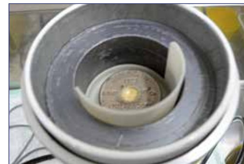
Bohrloch mit ^{137}\text{Cs} Prüfstrahler
