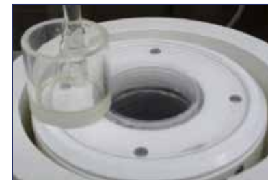
Messschacht eines Aktivimeters mit Einsatz
